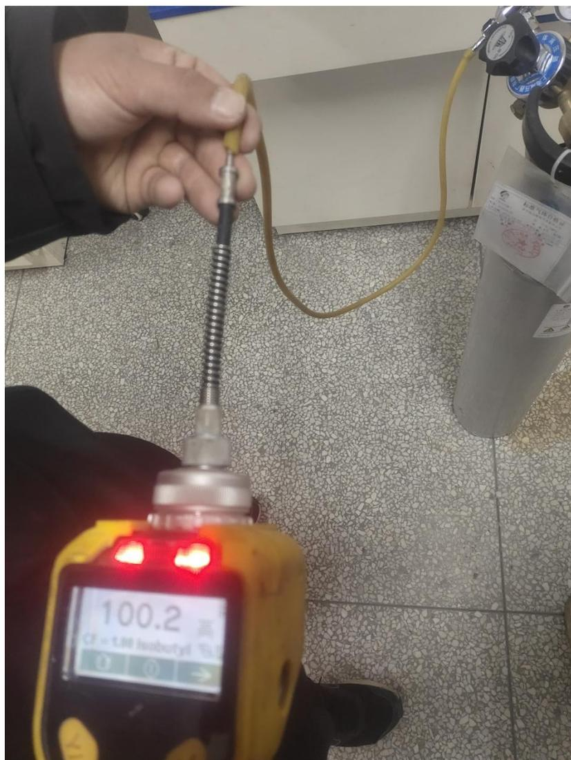
图 6.2-1 PID 校准
